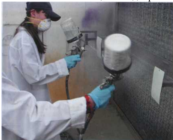
Нанесение колористом краски на тест-пластину аналогично ее нанесению на деталь.
